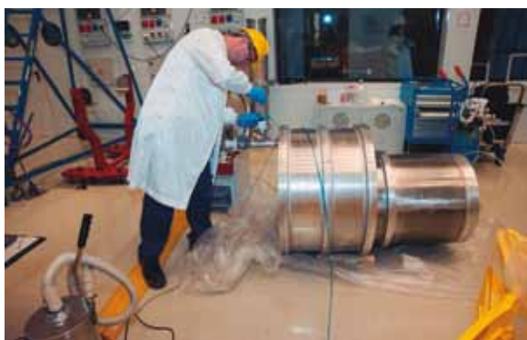
Primeras pruebas de vacío y fugas de la carcasa del criostato del TGI en el IAC.
