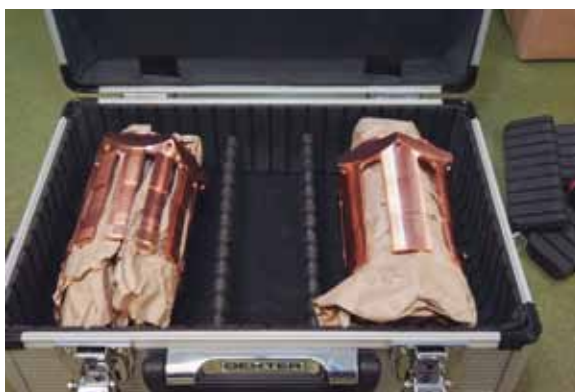
Prototipo de las coronas de cobre (enlaces térmicos) para el criostato del TGI.
