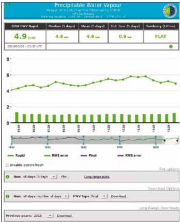
Fig. 4. Interfaz del PWVMO en el ORM, proporcionando datos en tiempo real del vapor de agua cada 30 minutos a través de la página Web www.iac.es/site-testing/PWV_ORM .
