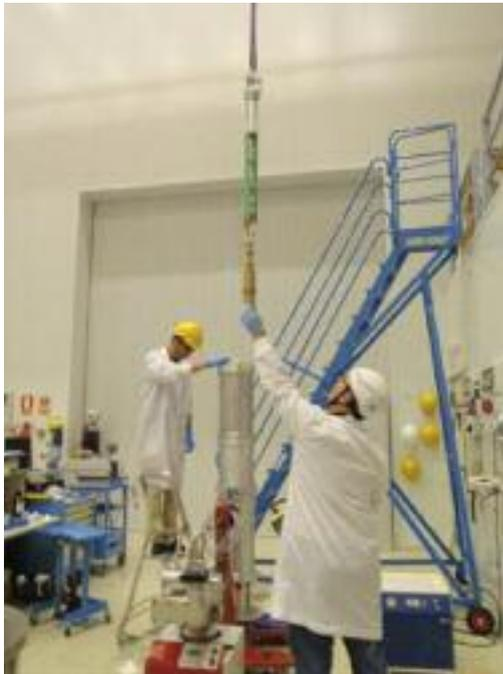
*Integración de un píxel en el criostato de pruebas.*
