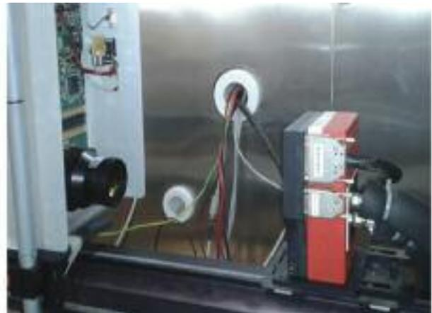
*Izquierda: Caracterización radiométrica en laboratorio del IAC usando un sistema semicomercial (INO – EUSO-Balloon). Derecha: Electrónica de diseño especializada “breadboard” SENER – IAC.*
