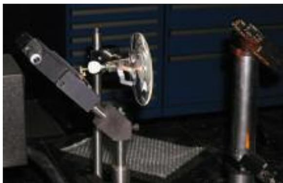
Detalle de las pruebas con lente plano-convexa para el sistema de expansor fuera de eje.
