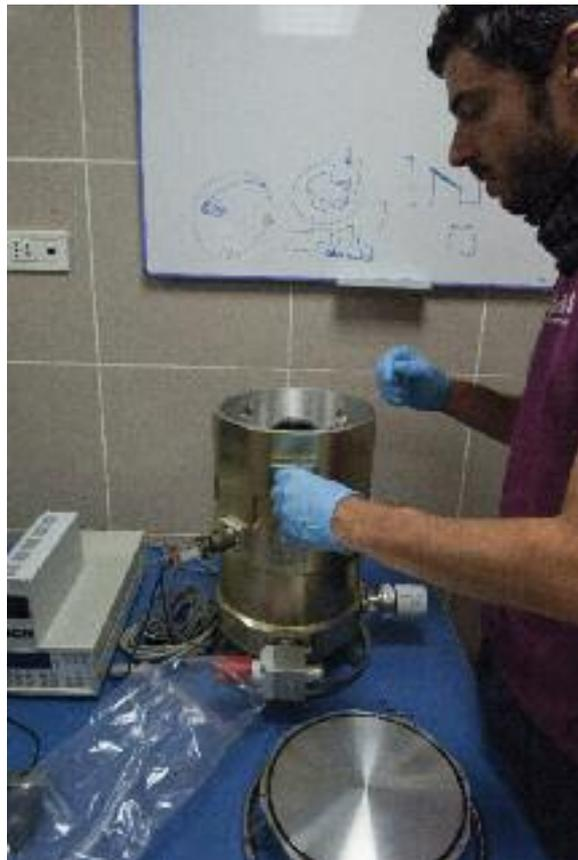
*Preparación del criostato de pruebas para la cualificación criogénica del codificador.*
