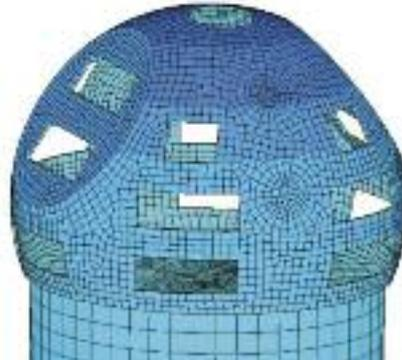
*Análisis térmico del telescopio EST con cúpula.*
