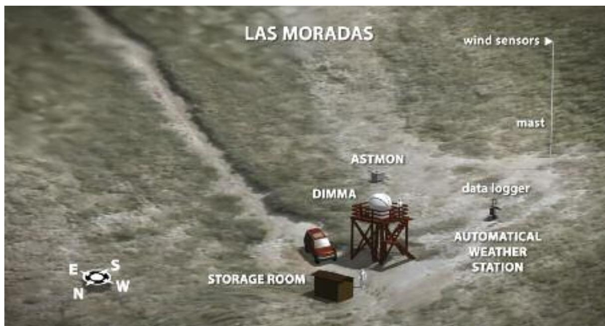
Figura 1: Esquema de los equipos de site testing instalados en las Moradas (ORM), a 300 m al oeste del telescopio GTC: DIMMA-ORM, AWS y ASTMON. (G. Pérez SMM).
