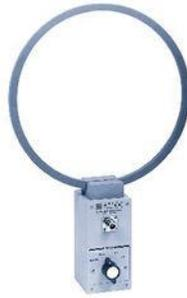
Antena EMCO 6509 (1KHz- 30MHz)
