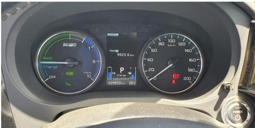
En el “reloj” de la izquierda, la zona azul, “charge” indica que el coche está regenerando energía, la zona verde indica un consumo normal, la zona blanca indica consumo alto de energía y cuando pasa a la zona azul con el 1, 5 y 10 indica que se ha activado el motor de combustión y la escala son decenas de kW de potencia que el motor de combustión está suministrando a los motores eléctricos que mueven el coche.
