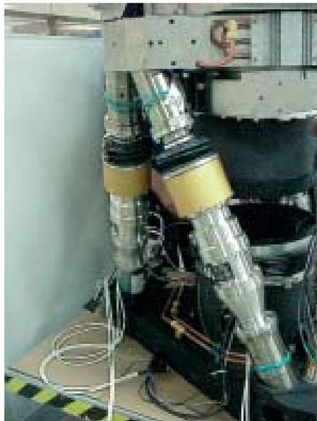
Arriba a la izquierda, accionamientos del espejo secundario. Abajo, detalle del hexápodo del espejo secundario.
