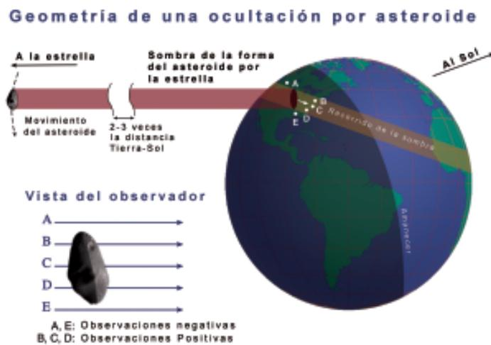
**Figura 14.** Representación esquemática de una ocultación de estrella por asteroide. El asteroide (situado a una distancia típica de 2 ó 3 veces la de la Tierra al Sol) oculta a la estrella siguiendo una trayectoria que determina el recorrido de su sombra por la superficie de la Tierra. Situando a observadores dispuestos perpendicularmente a este recorrido es posible establecer con precisión su forma y dimensiones (créditos David W. Dunham, IOTA / Johns Hopkins Univ. – Applied Physics Lab.)
