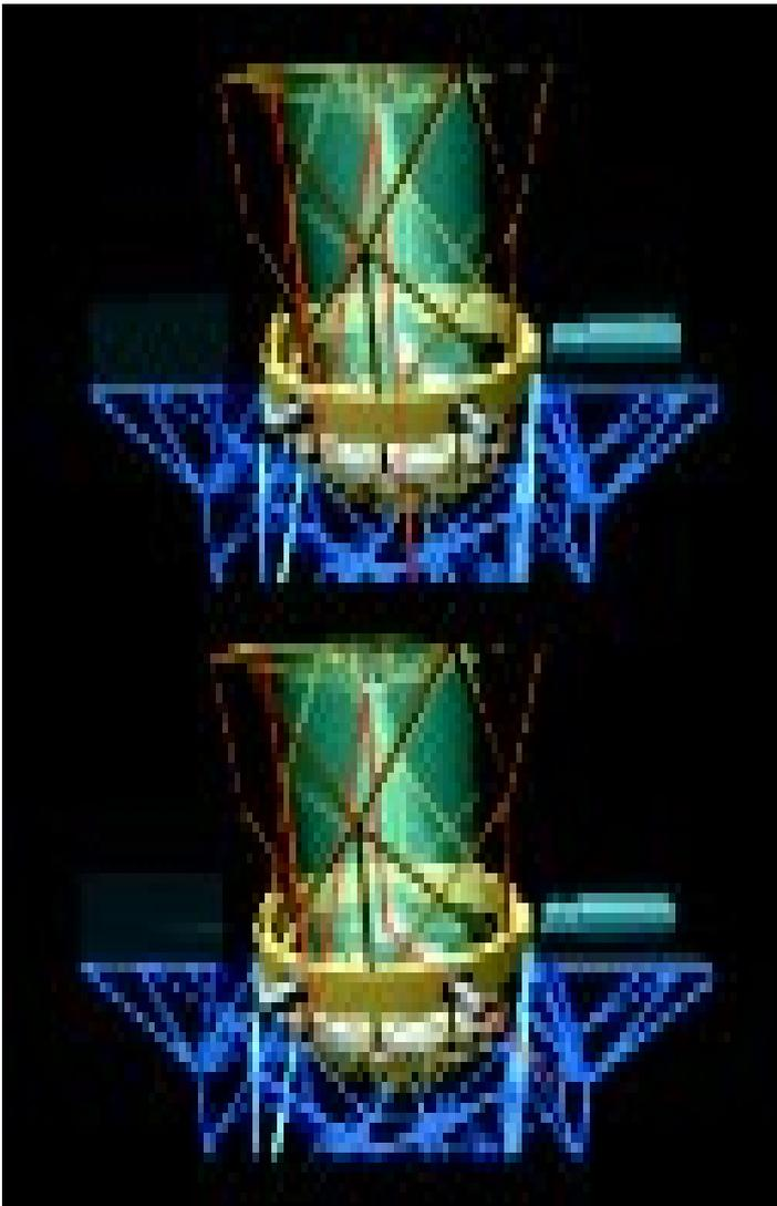
El anillo de elevación es una viga circular de sección cuadrada de 40 toneladas, con dos estructuras radiales a los lados que enganchan los motores y permiten que el tubo gire. El anillo, para el que se prevé una deformación de 1,5 milímetros, soporta todo el peso de la parte superior del tubo y lo transmite a la montura, en cuyas bases se concentra el mayor porcentaje de carga del telescopio.
