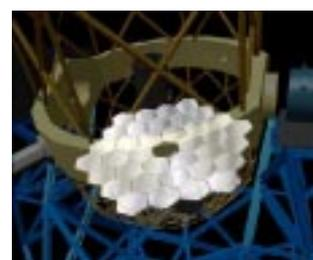
Detalle de la estructura del GTC, con el espejo primario segmentado. (Imagen: Gabriel Pérez, IAC).
