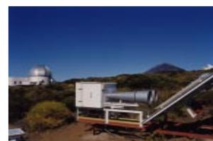
*Radiómetros del Experimento de Tenerife, instalados en el Observatorio del Teide.*
