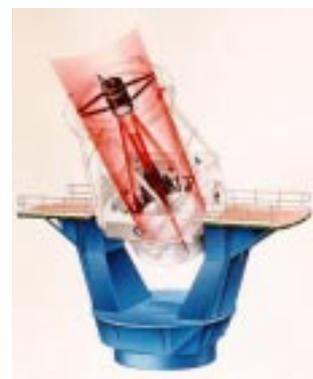
El WHT es un telescopio con montura altazimutal. © ING
