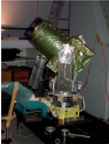
LUCE-EM, modelo de ingeniería del terminal óptico del satélite japonés OGS-EM, calibrado en los enlaces ópticos entre OGS-EM y ARTEMIS para verificar la compatibilidad de septiembre del terminal
