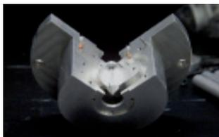
*Figura 10: Componentes (modulador y bocina) que se construyeron para instalar en el telescopio COSMOSOMAS, como prototipo de funcionalidad de QUIJOTE.*
