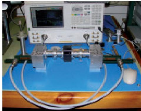
Figura 7: Medidas de parámetros "S" de microondas del modulador de banda 10-15GHz para el primer instrumento QUIJOTE. En la foto se aprecia el analizador de redes vectorial PNA y dos separadores de polarización ortogonal lineal (OMTs) a cada lado del modulador.
