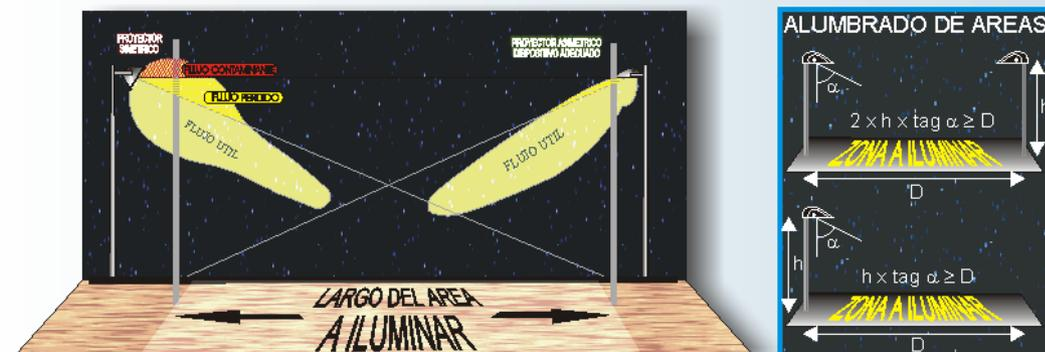
En cualquier caso, el haz principal de un proyector nunca debe superar los 65°-70° de inclinación, pues ello supondría un elevado deslumbramiento a los usuarios y pérdida de eficiencia en la instalación.
