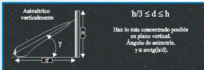
Gráfico de utilización de proyectores asimétricos en función del haz luminoso.
