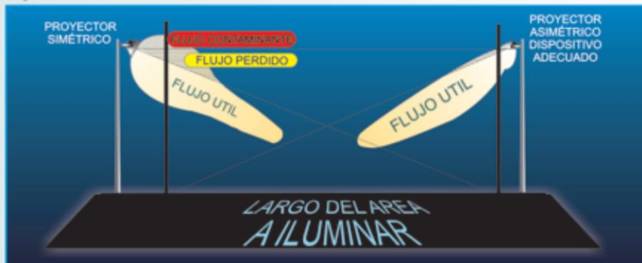
La inclinación máxima de los proyectores viene indicada en la lista de proyectores publicada por el IAC. El apagado de la instalación a partir de medianoche sobre cualquier maniobra manual debe garantizarse con el uso de un interruptor horario programable con reserva mínima de marcha de 100 horas.
