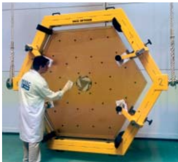
Manipulación del segmento maestro anclado. © SAGEM
