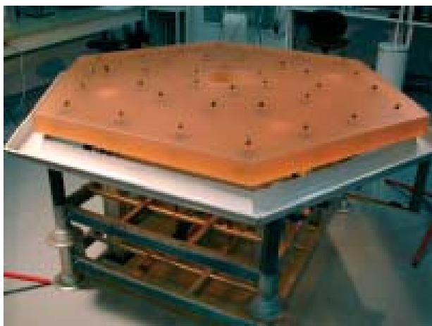
Bloque de zerodur con los anclajes, preparado para el proceso de pulido. © SAGEM
