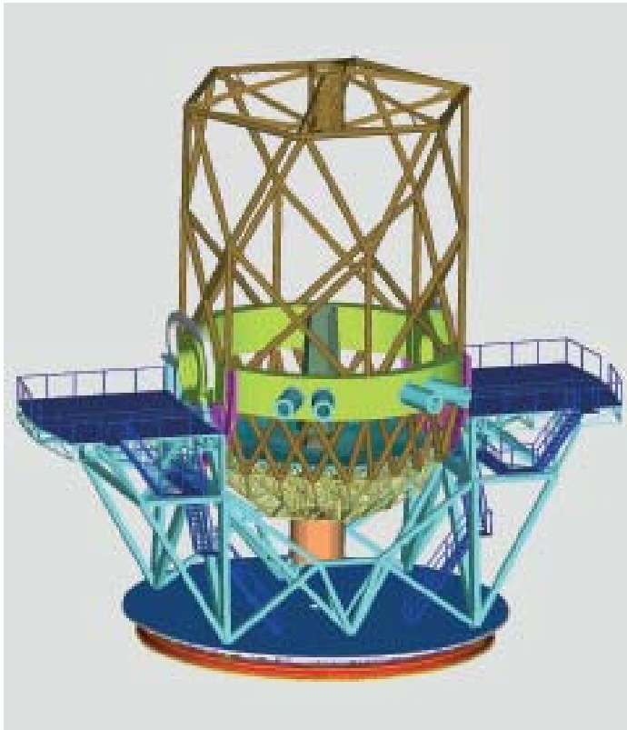
Estructura del GTC con sus dos plataformas Nasmyth a ambos lados. En una de ellas se instalará el instrumento OSIRIS.
